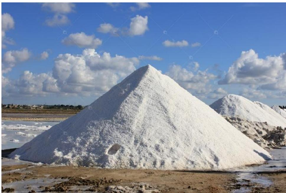
*Saline di Trapani. Sfruttando elementi naturali come il vento, il sole ed il mare, attraverso il passaggio dell'acqua in vasche di diversa dimensione e profondità, si ottiene il sale marino per effetto dell'evaporazione e della conseguente precipitazione.*
